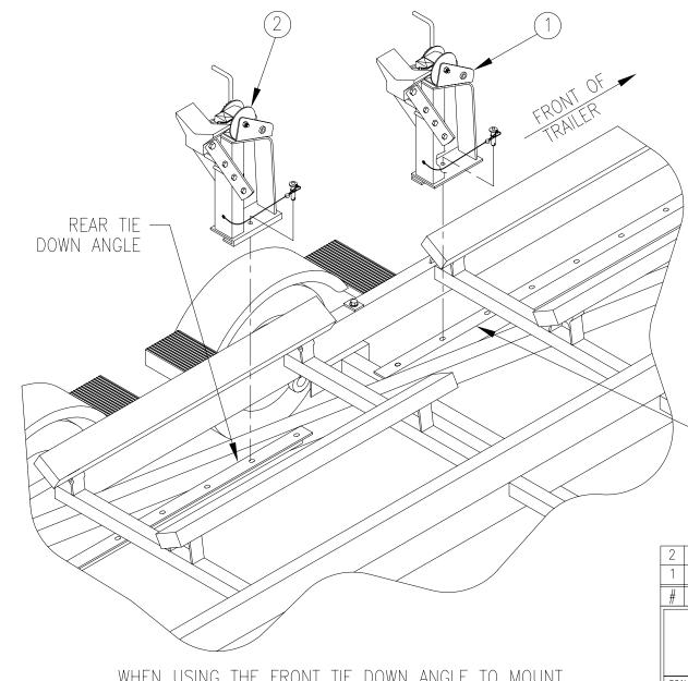
WHEN USING THE FRONT TIE DOWN ANGLE TO MOUNT ADD-ON BOW ASSEMBLY USE LEFT-HAND BOW ASSEMBLY ON THE DRIVER'S SIDE AND RIGHT-HAND BOW ASSEMBLY ON THE PASSENGER'S SIDE. FOR THE REAR TIE DOWN ANGLE USE THE RIGHT-HAND BOW ASSEMBLY ON THE DRIVER'S SIDE AND THE LEFT-HAND BOW ASSEMBLY ON THE PASSENGER'S SIDE.
